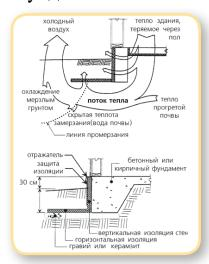
При отсутствии отапливаемого подвального помещения теплопотери через цокольное перекрытие, цоколь и фундамент могут достигать 20% от общих потерь дома. Утепление перекрытия 1-го этажа, которое опирается на фундамент, необходимо проводить вместе с утеплением цоколя снаружи.
